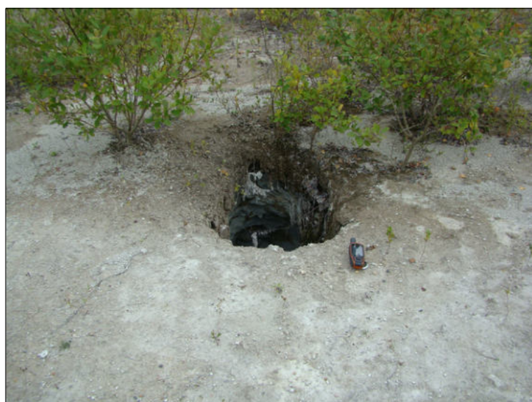
Fig. 53 : Dépression présentant un effondrement d'environ 1 m de diamètre, les parois présentent un dévers marqué s'étendant à plusieurs mètres autour du fontis (désordre n° 3 dans l'étude BRGM) [Source : IMS RN ]
