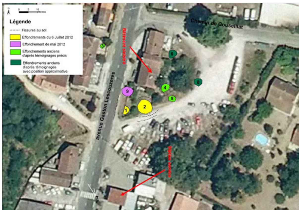
Fig. 41 : Carte des désordres relevés dans le cadre de l'expertise [Source : BRGM]
